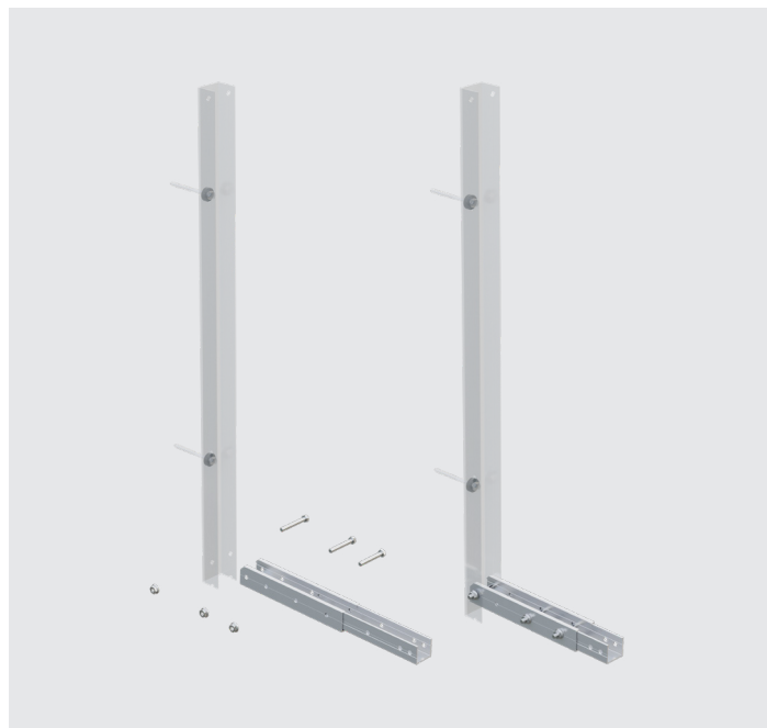
SCHRITT 2: Verstellprofile mit den vorgesehenen Sechskantschrauben und Sechskanmuttern an den Grundprofilen montieren. Durch die verschiedenen Befestigungspunkte können unterschiedliche Einstellungswinkel gewählt werden.
